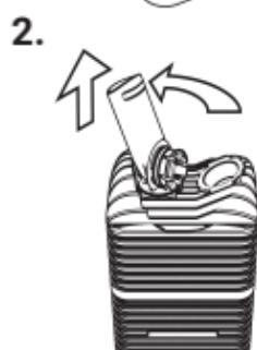
Steek de rand van het Mondstuk in de inkeping van de Roterende Deksel en draai het tegen de wijzers van de klok in om het te openen en eruit te trekken. Trek de Afdichtring van het Roterende Deksel door gebruik te maken van de uitsparing.
