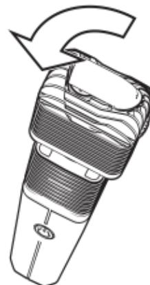
Démonter l'Unité de Refroidissement du Vaporisateur en la dévissant de 90° dans le sens inverse des aiguilles d'une montre.
