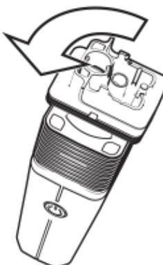
Svitare il fondo dell'Unità di Raffreddamento dal Vaporizzatore compiendo una rotazione di 90° in senso antiorario.
