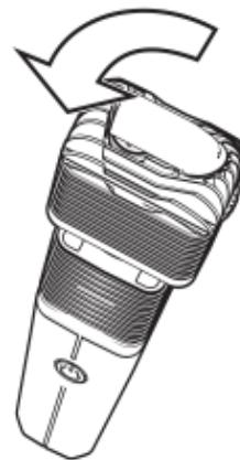
Enrosque la Unidad de Enfriamiento del Vaporizador girando 90° en sentido contrario a las agujas del reloj.
