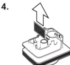
Das Sieb aus der Kühleinheit ziehen.
