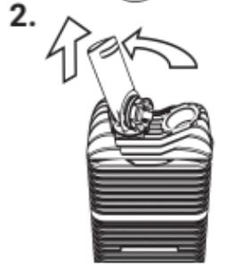
Coloque el borde de la Boquilla en la muesca de la Tapa Giratoria, gire en el sentido contrario a las agujas del reloj para abrir y tire. Retire el Anillo de Sellado de la Tapa Giratoria usando el hueco.
