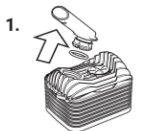
Extraiga la Boquilla moviéndola e inclinándola ligeramente de la tapa de la Unidad de Enfriamiento. Retire el Anillo de Sellado de Boquilla usando el hueco.
