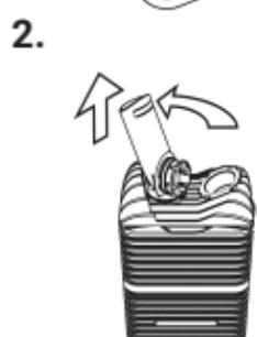
Um den Drehverschluss zu öffnen, den Rand des Mundstücks in die Einkerbung des Drehverschlusses stecken, entgegen dem Uhrzeigersinn drehen und ihn herausziehen. Den Dichtring mit Hilfe der Aussparung vom Drehverschluss abziehen.
