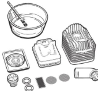
Immergere tutti i componenti dell'Unità di Raffreddamento in acqua di lavaggio calda.
