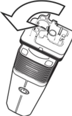
Kühleinheitsboden durch eine 90° Drehung entgegen dem Uhrzeigersinn vom Verdampfer abschrauben.
