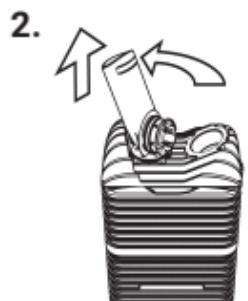
Mettere il bordo del Boccaglio nell'incavatura del Coperchio Girevole e ruotare in senso antiorario per aprire e togliere. Staccare l'Anello di Tenuta del Coperchio Girevole usando la rientranza.
