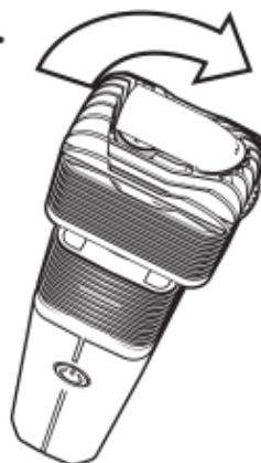
Visser l'Unité de Refroidissement sur le Vaporisateur en la tournant de 90° dans le sens des aiguilles d'une montre.
