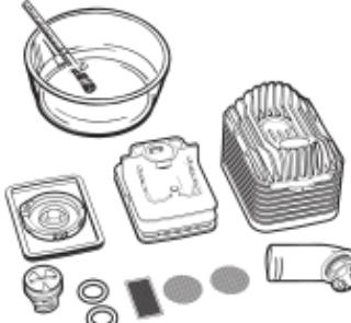
Alle Teile der Kühleinheit in warmes Spülwasser einlegen. Alternativ: Alle Teile der Kühlseinheit sowie das Füllkambersieb maximal 1/2 Stunde in Isopropylalkohol einlegen. Alle Teile mindestens eine Minute unter fließendem Wasser abspülen. Alle Teile vollständig trocknen lassen.
