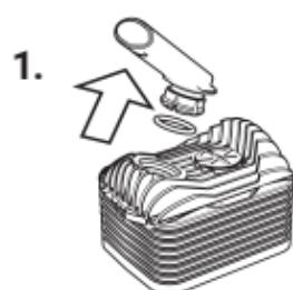
Mundstück unter leichtem Hin- und Herkippen aus Kühleinheitdeckel herausziehen. Mundstückdichtring mit Hilfe der Aussparung abziehen.
