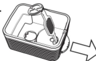
Utiliser l'Outil de Chambre de Remplissage pour pousser la Molette de Réglage hors de l'Unité de Refroidissement.
