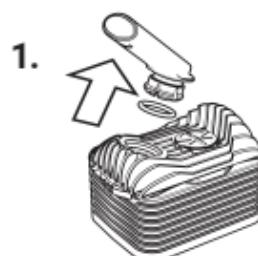
Trek het deksel van de Koeleenheid van de Verdampert. Trek de Afdichtring Mondstuk los via de uitsparing.
