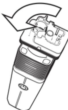
Schroef de bodem van de Koeleenheid los van de Verdamper door hem 90° tegen de wijzers van de klok in te draaien.
