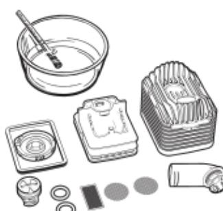
Poser toutes les pièces de l'Unité de Refroidissement dans de l'eau de rinçage tiède. Une autre solution consiste à laisser les pièces de l'Unité de Refroidissement pendant une demi-heure au maximum dans l'alcool isopropylique. Rincer toutes les pièces sous l'eau courante pendant au moins une minute. Laisser toutes les pièces complètement refroidir.
