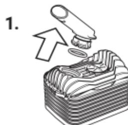
Démonter l'Embout du couvercle de l'Unité de Refroidissement en le tournant légèrement dans les deux sens. Retirer le Joint d'Embout à l'aide de l'encoche.
