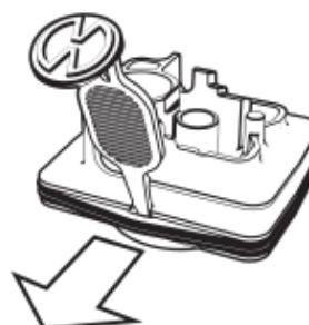
Dégager le grand Joint de Base sur l'évidement de rainure à l'aide de l'Outil de Chambre de Remplissage.
