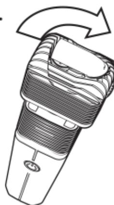
Enrosque la Unidad de Enfriamiento girándola 90° en sentido de las agujas del reloj sobre el Vaporizador.
