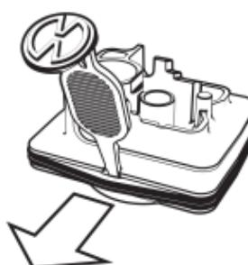
Estrarre il grande Anello di Tenuta del Fondo facendo leva con l'Utensile del Contenitore sull'apertura della scanalatura.
