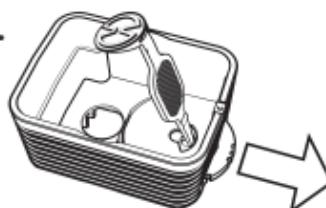
Use la Herramienta del Depósito para presionar la Rueda de Ajuste hasta extraerla de la Unidad de Enfriamiento.
