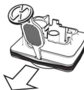
Haal de grote Bodemafdichtring met Vulkamerhulp-middel uit de uitsparing in de groef.
