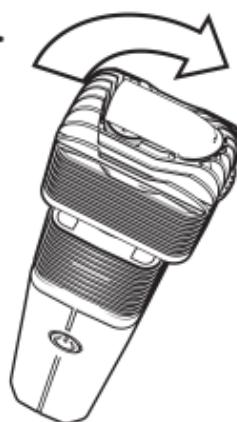
Avvitare l'Unità di Raffreddamento sul Vaporizzatore compiendo una rotazione di 90° in senso orario.
