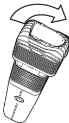
Kühleinheit durch eine 90° Drehung im Uhrzeigersinn auf den Verdampfer anschrauben.
