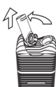
Placer le bord de l'Embout dans l'entaille du Couvercle Rotatif et le faire tourner dans le sens inverse des aiguilles d'une montre pour l'ouvrir et le retirer. Retirer le Joint du Couvercle Rotatif à l'aide de l'encoche.
