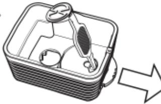
Das Einstellrad mithilfe des Füllkammerwerkzeugs aus der Kühleinheit drücken.
