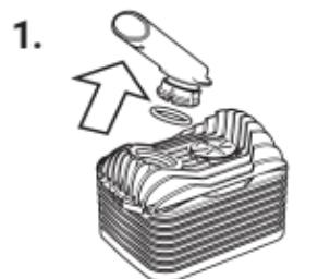
Estrarre il Boccaglio dal coperchio dell'Unità di Raffreddamento muovendolo leggermente avanti e indietro. Staccare l'Anello di Tenuta del Boccaglio usando la rientranza.
