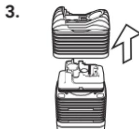
Trek het deksel van de Koeleenheid van de Verdampert.
