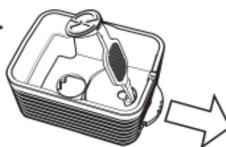
Gebruik het Vulkamerhulp-middel om het Luchtstroom Draaiwheel uit de Koeleenheid te drukken.
