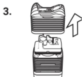
Tire de la tapa de la Unidad de Enfriamiento del Vaporizador.
