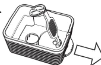
Usare l'Utensile del Contenitore per spingere la Monopola di Regolazione fuori dall'Unità di Raffreddamento.
