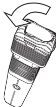
Schroef de Koeleenheid los van de Verdamer door hem 90° tegen de wijzers van de klok in te draaien.
