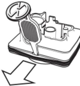
Großen Bodendichtring mit Füllkammerwerkzeug an der Aussparung in der Nut aushebeln.
